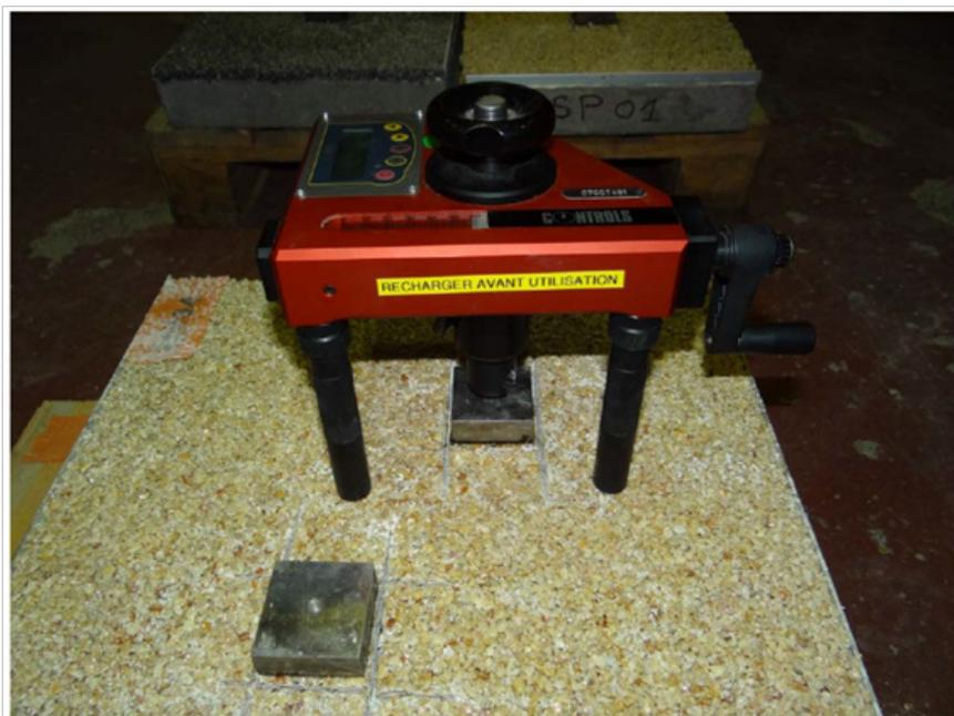
Photographie n° 2 : Dispositif de traction
